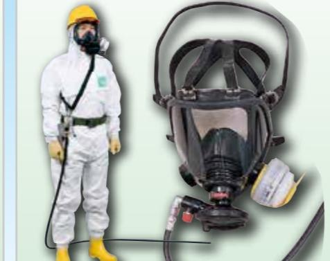
最適な呼吸用空気を供給する給気・ろ過両用式呼吸用保護具。フィルタ内蔵で面体を外さずに汚染シャワーが使用可。
