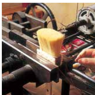
28.綴 締め機でしっかり固定し、穴をあけ、銅線(又は、三味線の糸)で縫い付けます。
